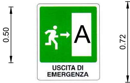
CARTELLO "USCITA DI EMERGENZA" DA POSIZIONARE IN CORRISPONDENZA DELLE VIE DI FUGA DELLA RECINZIONE PERIMETRALE MONTATO SU PALO H=4.00 mt. (n°8)
